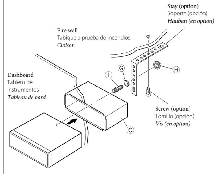
Install the unit at an angle of less than 30°. *Instale la unidad a un ángulo de menos de 30°.*
